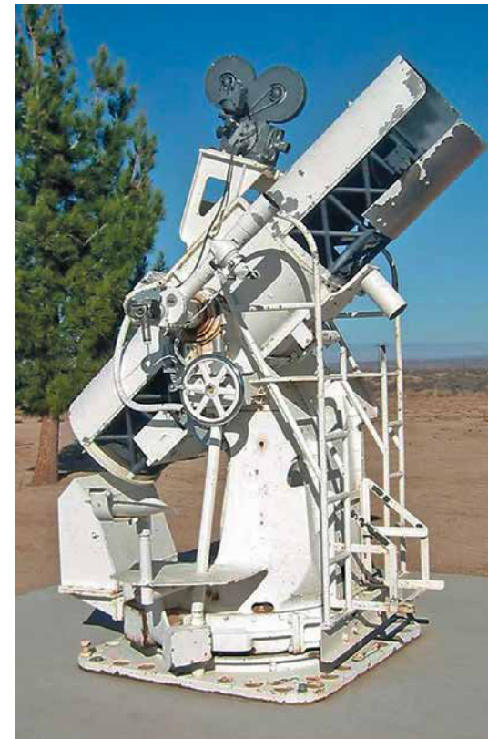
Le cinéthéodolite IGOR développé par Clyde Tombaugh pour les tests de missiles. Noter la caméra fixée au sommet pour filmer et suivre les engins dans le ciel. (White Sands Missile Range Museum)
